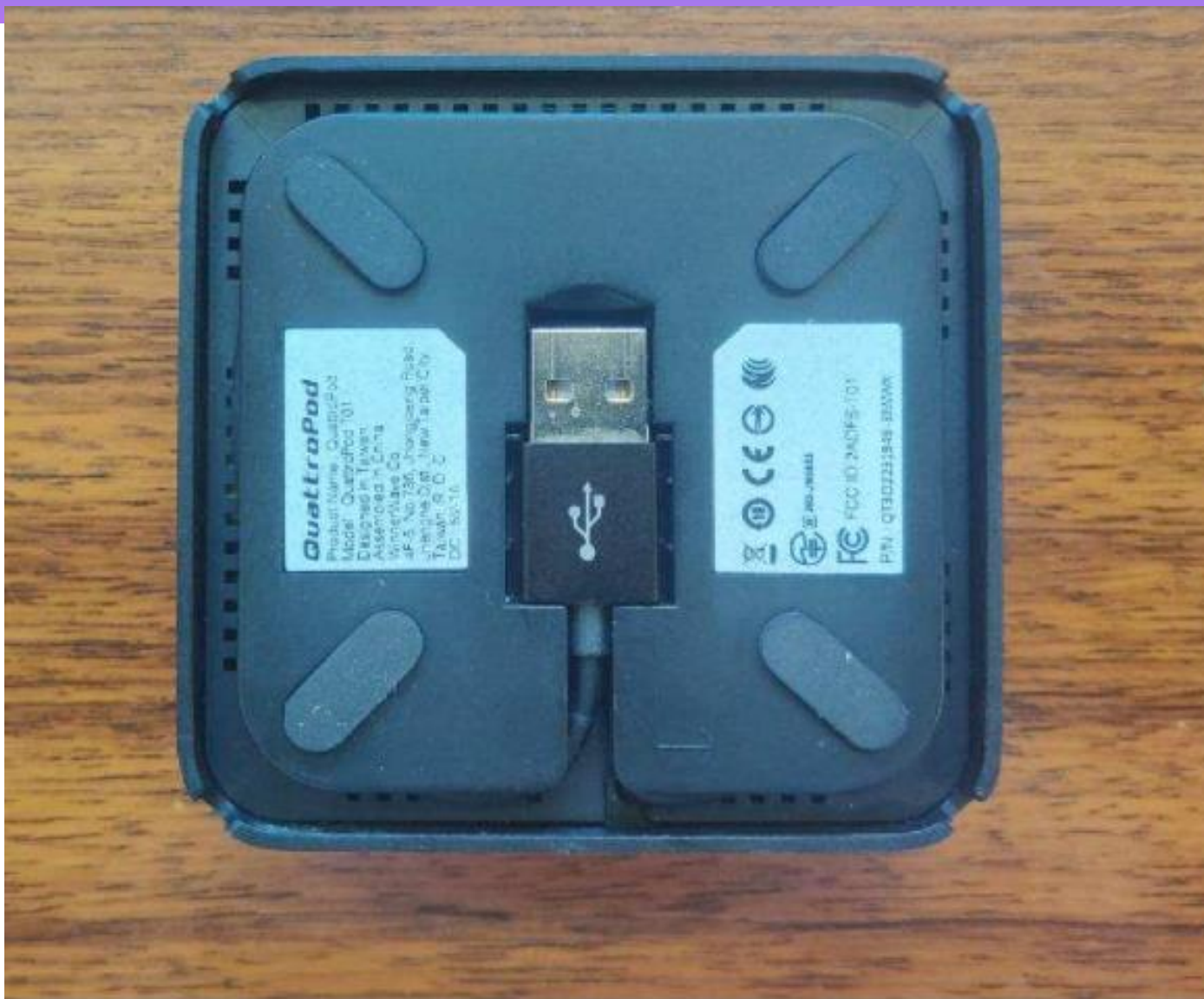
le câble USB se trouve en dessous de l'émetteur
