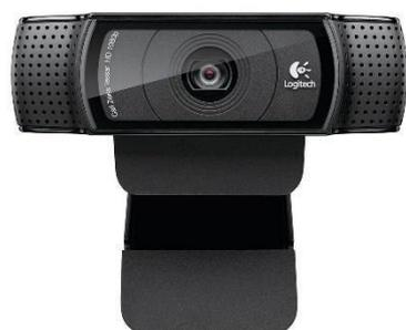
La Logitech C920 n'est pas à proprement dit une caméra, il s'agit d'une webcam, filmant en full HD (1080p) avec un taux de rafraîchissement de 30 fps (30 images par seconde) dans un angle de vue total de 78°. Elle s'alimente via un simple port USB 2.0.
